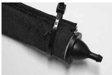
3. Duw tot aan de flens op de aansluiting en maak er een riempje omheen vast
